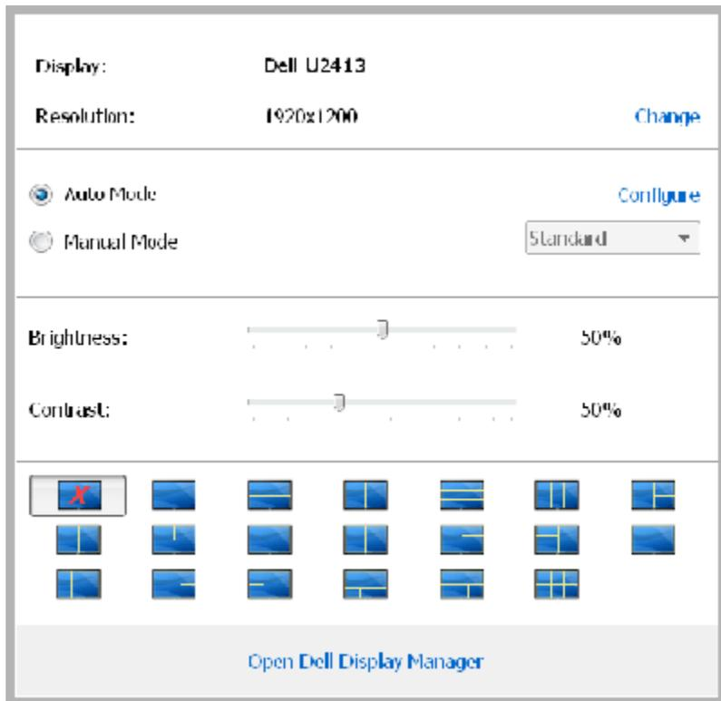
クイック設定のダイアログボックスからは、Dell Display Manager の高度なユーザー インターフェイスにもアクセスできます。ここからは、基本的な機能を調整したり、自動モードを設定したり、その他の機能にアクセスしたりすることが可能です。
